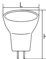
Галогенная лампа типа MR11. Предназначена для прямого подключения в электрическую сеть, не требует понижающих трансформаторов. Обладает высокой светоотдачей. Подходит для натяжных потолков.
